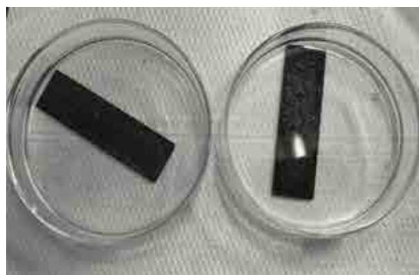
図 1 精製カラギナンを添加したクエン酸に、鉄を浸した様子。左から 0.16g、0.24g 添加したもの
