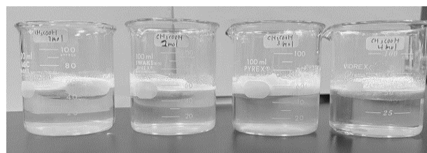
図 3 酢酸に浸した紙粘土(左から 1.0mol/L 2.0mol/L 3.0mol/L 4.0mol/L)
