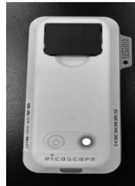
図6 吸光光度計（ピコスコープ）
