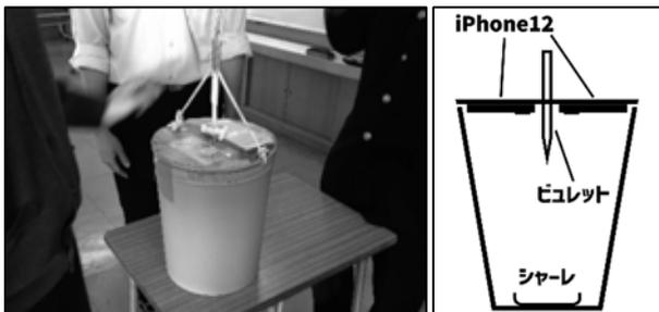
図1 ミルククラウン発生装置(左)と装置の断面(右)
