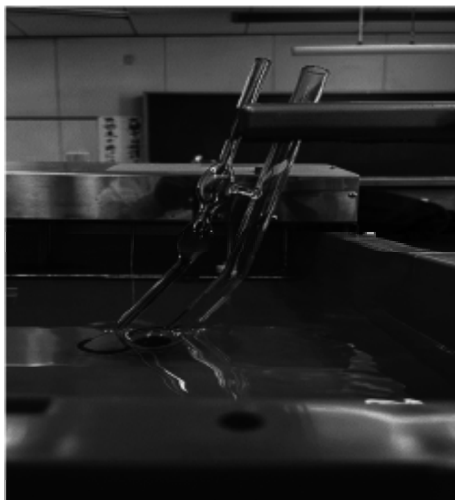
図1 毛细管粘度計と粘度を測定する様子
