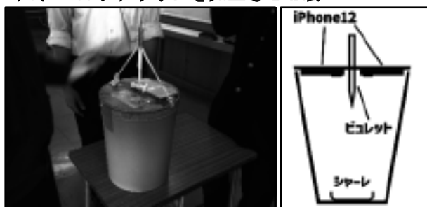
図1 ミルククラウン発生装置(左)と装置の断面(右)
