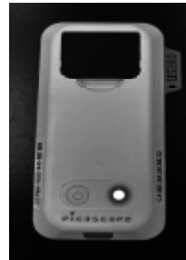
図6 吸光光度計（ピコスコープ）
