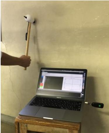
写真2 打音を収集している様子
