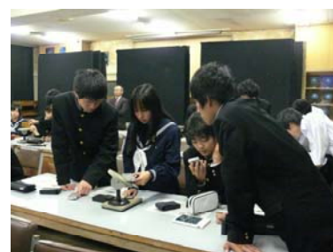
走向・傾斜の測定
